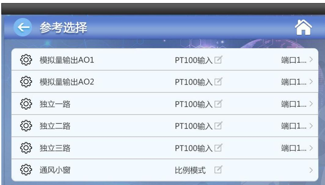
**模拟量输出 AO01、AO02 输出，独立输出：** 可以选择不同的参考传感器，输入类型可选：PT100 输入，4 - 20mA 输入,485 探头(预留)，可点击修改图标修改。最右边的选项为对应的输入端口类型的具体接口，可进入子菜单选择，蓝色为选中，选择多路则表示参考传感器取平均值。
