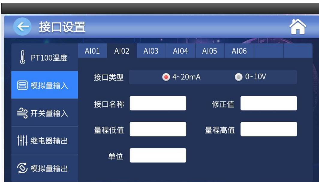
**接口类型：** 模拟量输入接口可以使用 4-20mA 或者 0-10V 类型的传感器，选择对应的接口即可。
