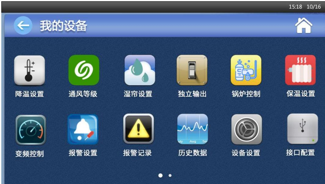
主菜单为所有参数设置和数据查询的入口，菜单有【工程模式】和【用户模式】两种操作模式，不同模式显示不同的菜单。其中：【系统配置】、【接口配置】、【接口设置】、【固件升级】、【参考选择】、【通风风机】在“工程模式”时才有显示，其它菜单在“管理员”模式就有显示。不同模式可以在【设备设置】输入不同的操作码切换，在【设备设置】>【操作代码】设置为“5678”系统进入“工程模式”，正常使用时需要把【操作代码】设置为“0000”退出“工程模式”，防止误操作。工程模式用于工程技术人员调试用，用户严禁进入。
