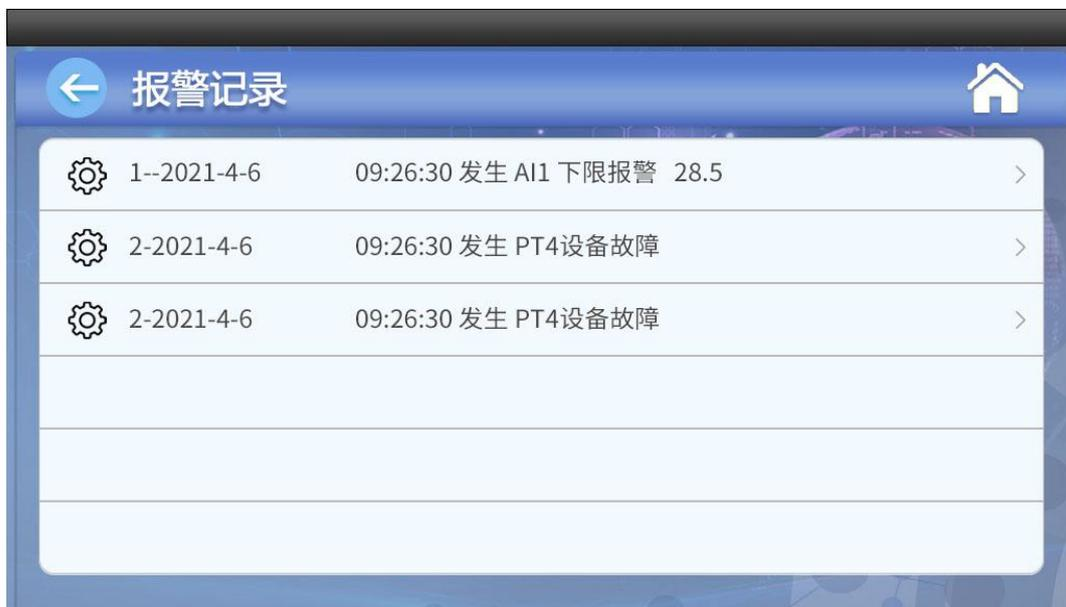
报警信息依次为报警序号、发生日期、时间、报警端口、报警内容、报警时的采集数据，报警信息最多支持 30 条记录，在报警页面按键进入清空报警信息界面，选择确定按钮可以清空历史报警信息。
