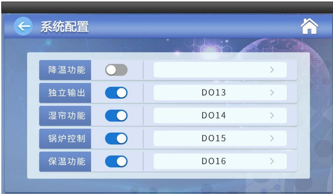
系统配置主要配置输出对应的接口，系统未用到的功能及时关闭，则主菜单不显示相应的设置菜单。“DO”表示继电器的输出，数值表示相对应的继电器路数，一项功能可配置多路连续的继电器，配置多路则相应功能增加一路。比如保温功能配置了 DO15，则主菜单会相应显示【保温设置】相应菜单。配置输出后确保相应的开关按钮为打开状态，否则配置无效。
