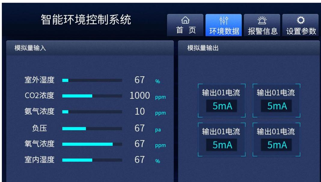
环境数据实时显示模拟量输入、模拟量输出接口的数值，模拟量输入柱状条会随着数值不同而变化。
