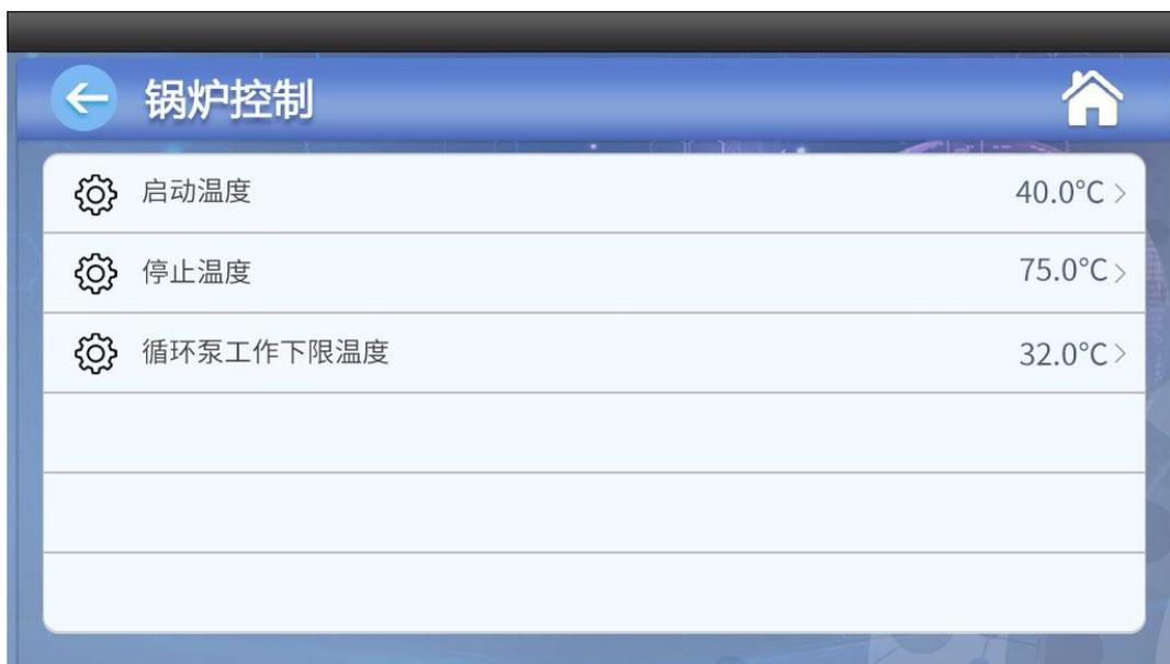
**启动温度**：当炉温探头温度低于此值时，启动锅炉控制输出继电器；
