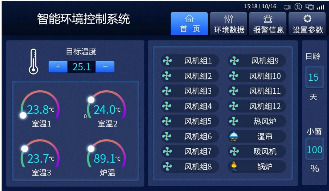
主界面实时显示目标温度、实时温度、设备状态、日龄等信息。目标温度在主界面通过“+”、“-”键可以更改。输出设备状态图标为绿色并且呈现动态效果，表示运行，反之灰色表示关闭，如果打开了生长曲线，目标温度值会随着日龄自动计算，精确到小时，每个小时的目标温度值可能不同。日龄会随着养殖天数自动调整显示。温度、继电器输出设备名称可以根据现场需求自由设置。
