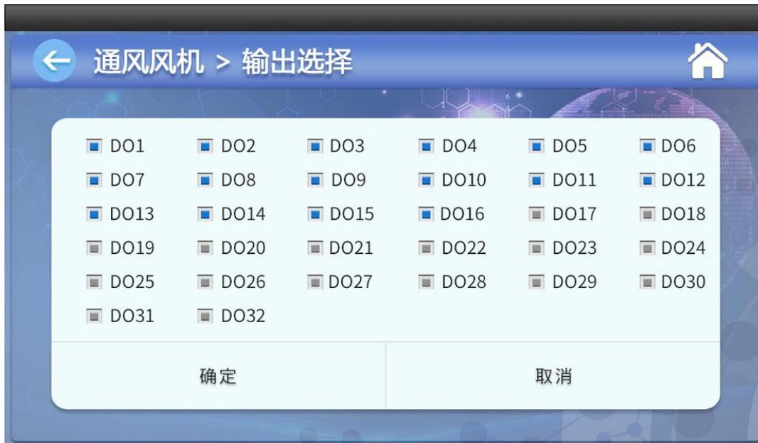
通风风机为最小通风时指定相应通风风机，当系统进入最小通风模式时在指定的通风风机中按通风等级设定的时间循环输出，要连续选择输出。
