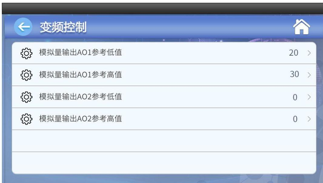
**模拟量输出 AO1，AO2 路低值**：变频器控制参考输入值低点。
